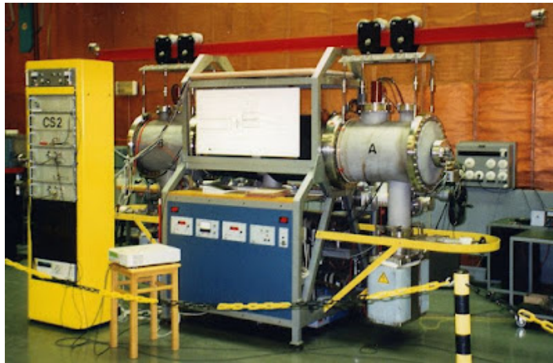
De Cesium Beam Standard in het Physikalisch Technischen Bundesanstalt in Braunschweig, Duitsland. (© 1997 Jörg Behrens)
