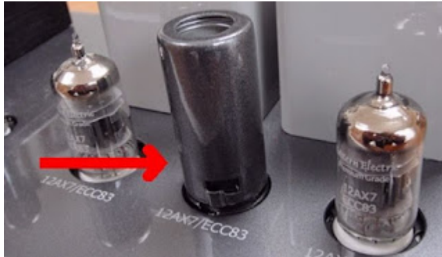
Een mu-metalen afscherming rond een buis in een high-end audioversterker. (© HiFi Forum)
