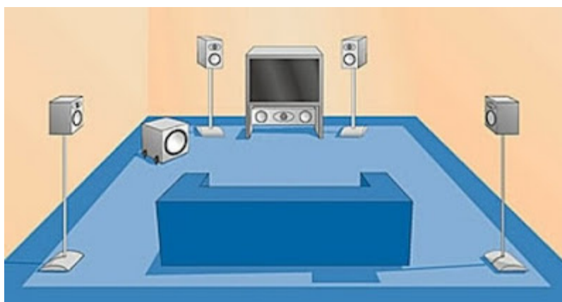
De opstelling van de zes luidsprekers in een 5.1-systeem.
